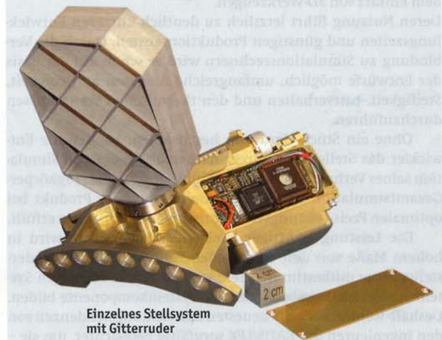
Gitterruderstellensystem integriert in Flugkörperheckstruktur
