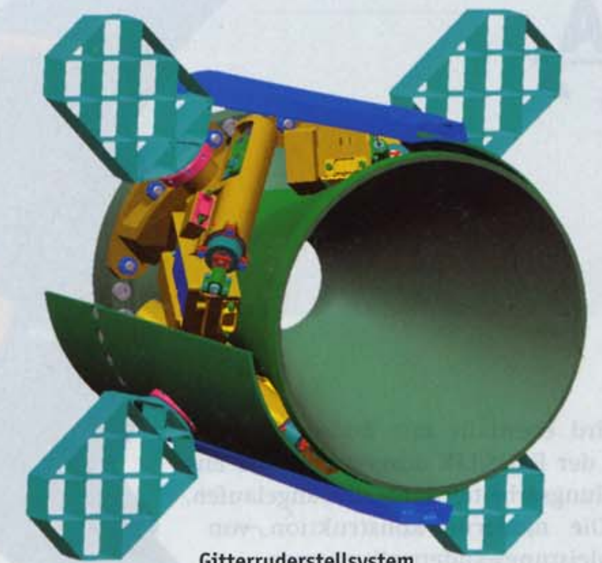
Gitterruderstellensystem integriert in Flugkörperheckstruktur
